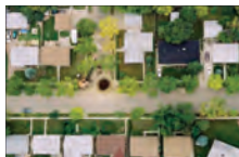
Example of an access shaft used for tunnel construction. Once construction is complete, the shaft allows maintenance access to the tunnel. Exemple d'un puits servant à la construction d'un tunnel. Une fois la construction terminée, le puits sert de point d'accès pour l'entretien.
